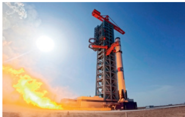
2025 年 10 月 18 日 -20 日，蓝箭航天朱雀三号遥一运载火箭（ZQ-3 Y1）在东风商业航天创新试验区液氧甲烷火箭 2 号发射工位顺利完成首飞任务的第一阶段加注合练及静态点火试验
